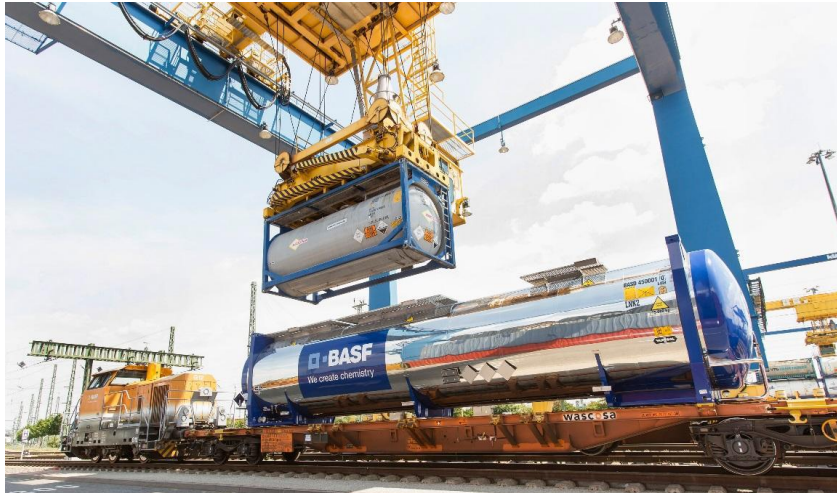
Bild 1: B-TC auf einem Tragwagen im Vergleich zu einem 20-Fuss-Tankcontainer.
