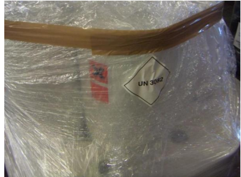
Fehlende Gefahrzettel und Kennzeichnung „Umverpackung“
